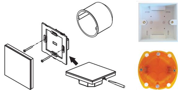
El controlador puede ser instalado en una caja (empotrable o de superficie) estándar de 60 mm.
